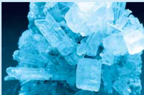
شکل ۵ ژیبس یا سنگ گچ، \text{CaSO}_4 \cdot 2\text{H}_2\text{O} ؛ نخستین ماده‌ای که به‌عنوان ساروج کاربرد یافت.
